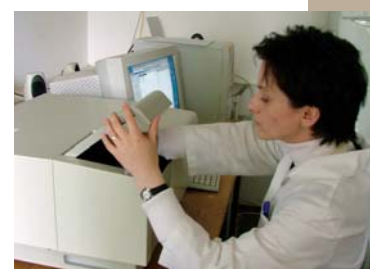
Măsurători de fotoluminescență (Spectrofluorimeter Wavel- JASCO FP-6500)
