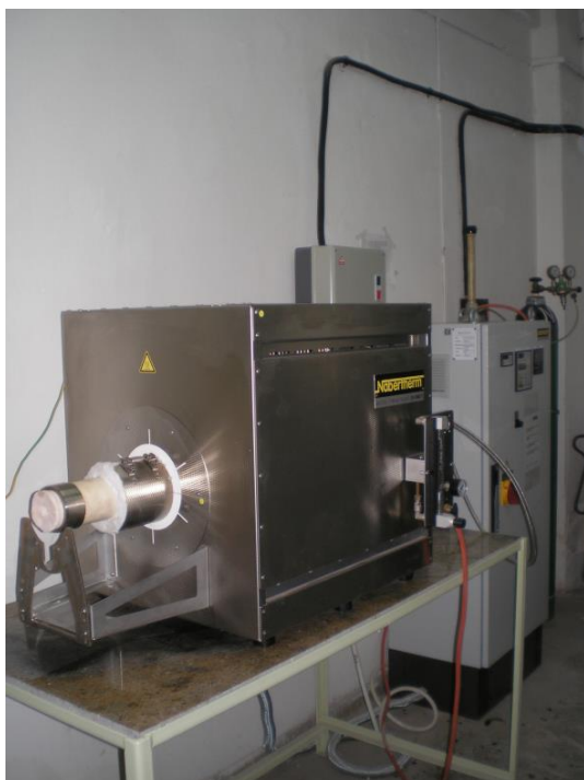
CUPTOR PENTRU TRATAMENTE TERMICE la <math>< 1600\text{C}</math> în aer/ vid/ gaz inert Nabertherm RHTH 120/ 300/16
